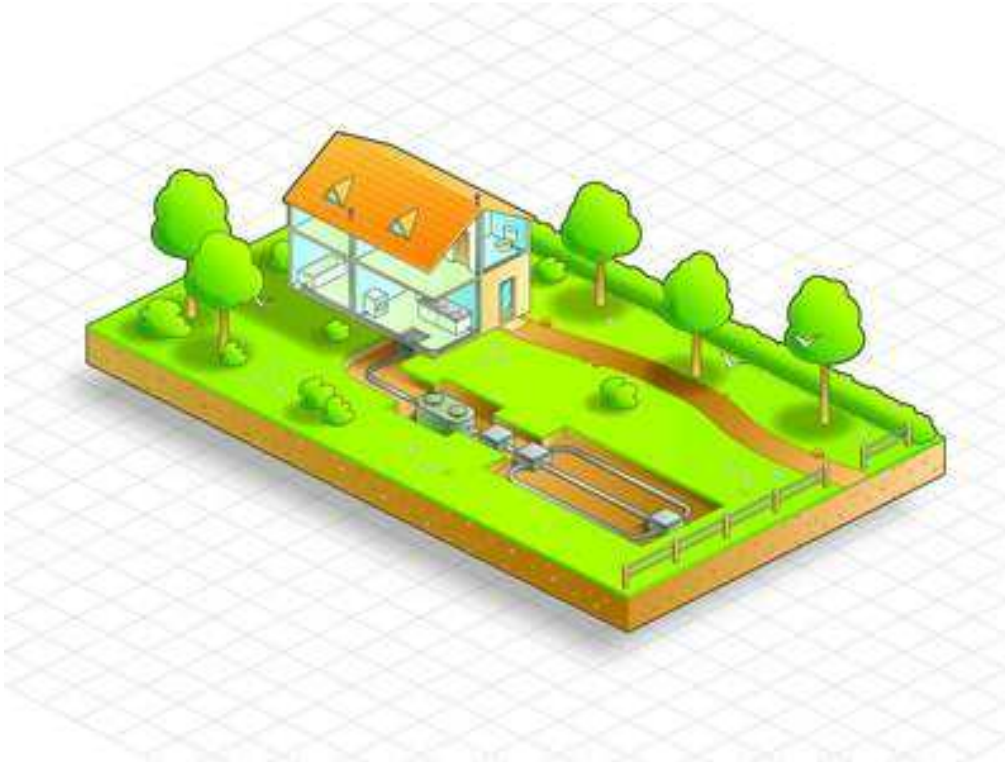
Assainissement individuel classique avec tranchée filtrante
