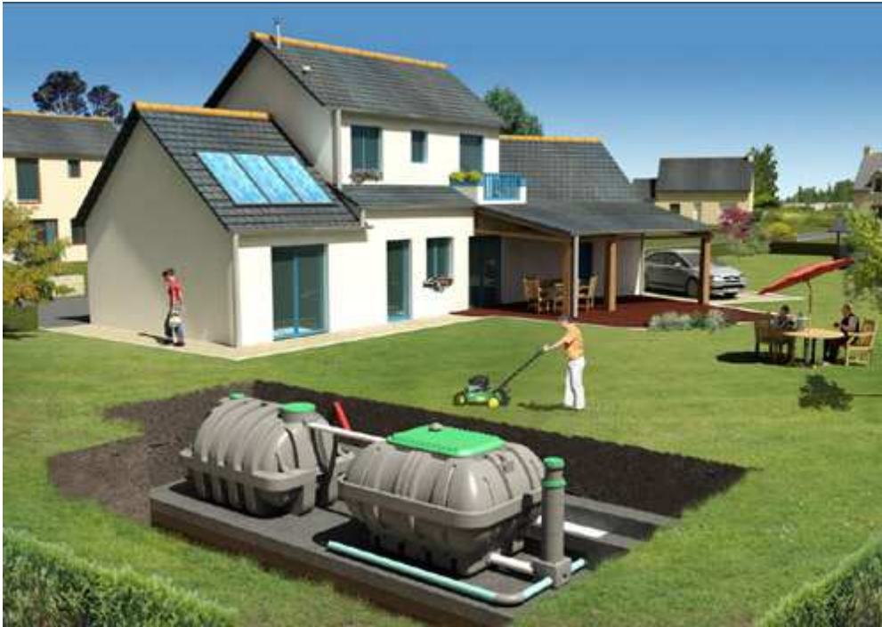
Nouvelles solutions : Station d'épuration individuelle
